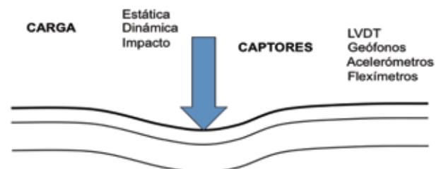
Esquema 1. Esquema medición deflexiones
