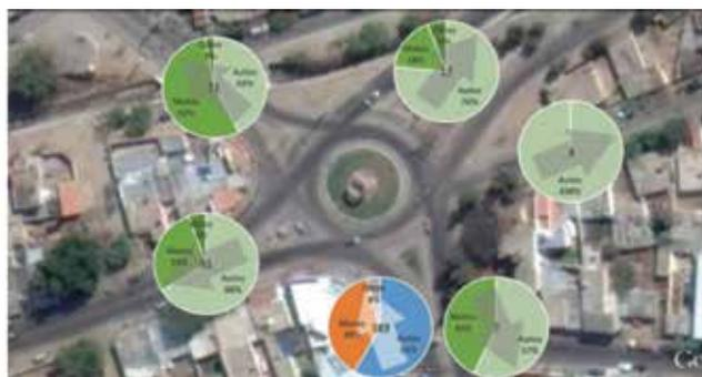
Figura 30. Trayectorias de vehículos que ingresan al nudo por posición 1
