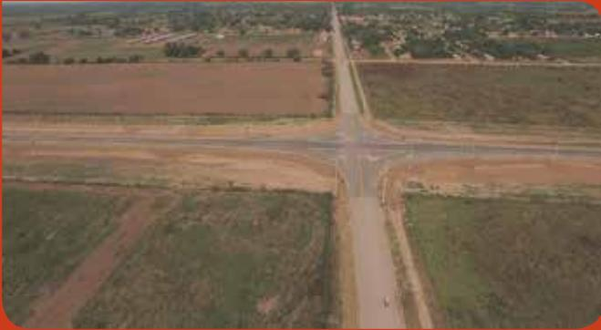
En Quitilipi se rehabilitó el acceso urbano a la localidad por la Av. Perón, en cuyo empalme con la RP N° 4 se construyó una intersección con obra de iluminación. También se repavimentó el sector norte de la Av. San Martín y se construyeron sumideros y alcantarillas para optimizar el funcionamiento de los canales que la cruzan.
