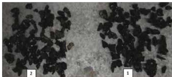
**Figura 10.** Adherencia árido-Ligante (AASHTO 182 modificado) tras 40 horas de inmersión
