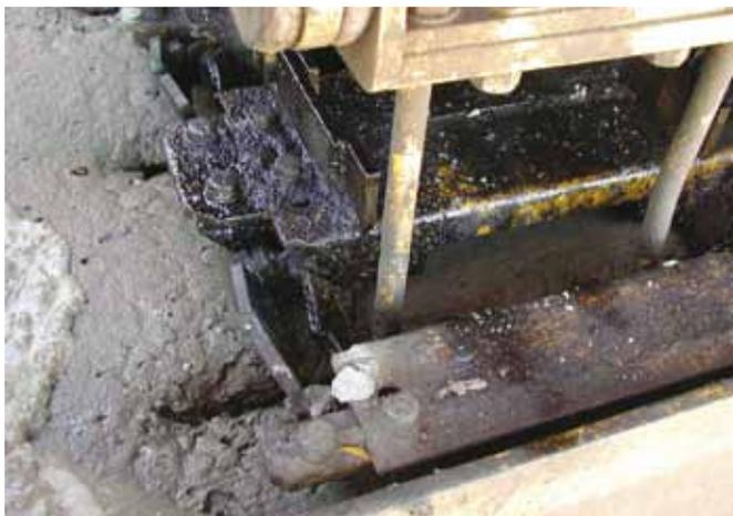
**Figura 10:** Detalle de insertor automático de pasadores.
