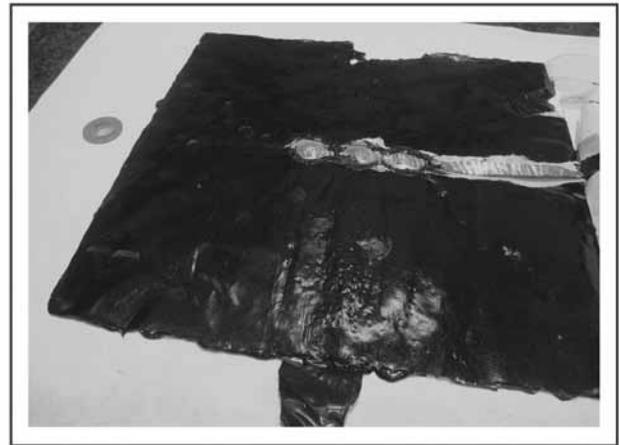
**Figura 14:** Lámina de betún con tres piezoeléctricos en sentido perpendicular al movimiento de la rueda.
