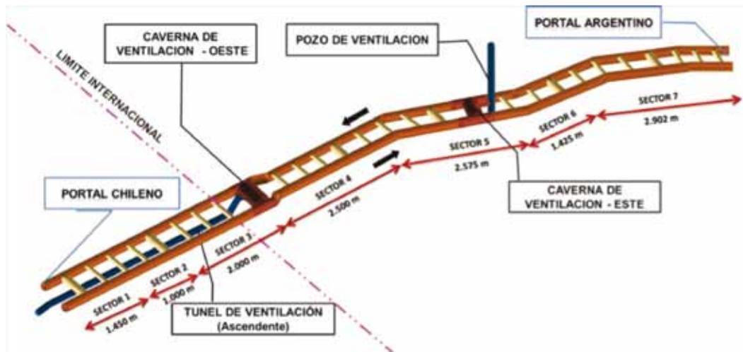
El proyecto del Túnel de Agua Negra se compone de las siguientes obras subterráneas:
