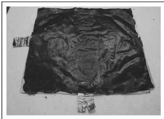
**Figura 13:** Lámina de betún con piezoeléctricos embebidos.
