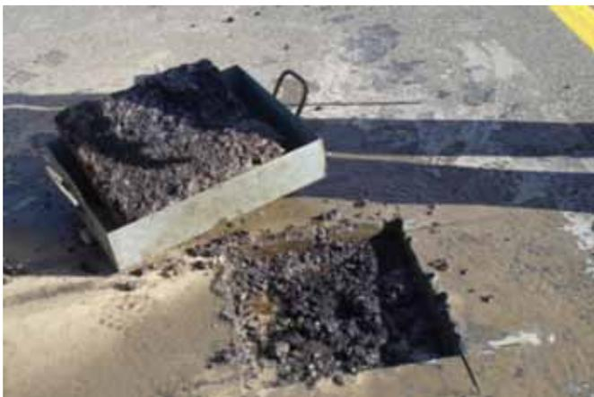
Fotografía N° 6. Extracción de muestra de pavimento en área exudada
