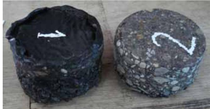
Fotografía N° 7. Testigos extraídos: 1 : sector contaminado; 2 : sector "sano"
