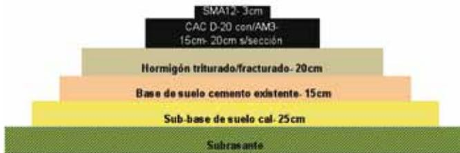
Figura 4. Perfil estructural proyectado
