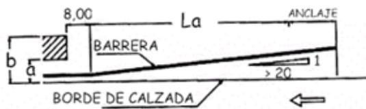
Si el obstáculo fuera un poste SOS, un poste de iluminación aislado o de un soporte de pórtico o banderola, la longitud mínima de aproximación paralela  $L_M$  se obtiene de la tabla siguiente:
