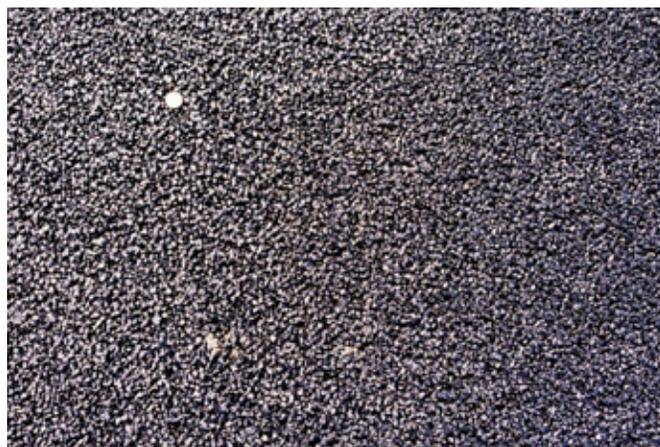
Foto 4: Mezcla bituminosa discontinua con árido siderúrgico.
