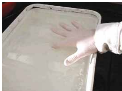
Figura 9: Membrana mal formada, frágil y quebradiza (control cualitativo)
