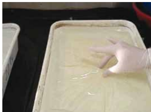
Figura 10: Membrana bien formada, flexible y resistente (control cualitativo)
