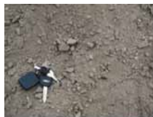
Figura 13: Aspecto de material granular 0 a 19 mm para subbase (estado seco)
