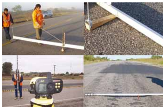
Fig. 3. Relevamiento de la calzada con perfilómetro transversal, nivel digital, regla y cuña.
