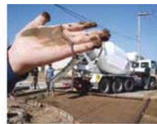
Figura 14: Plasticidad "visible", fracción fina de material granular 0 a 19 mm para subbase (estado húmedo)
