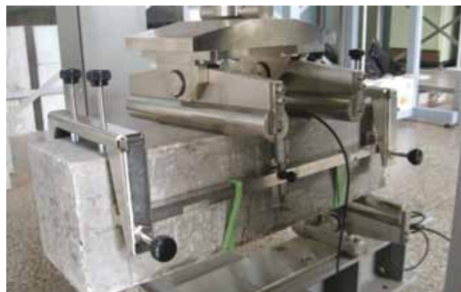
Fig. 12. Dispositivo de ensayo adquirido, para determinar la resistencia residual del HRF.
