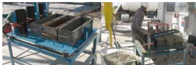
Fig. 11. Mesa vibratoria instalada al pie de la planta para el moldeo de probetas.
