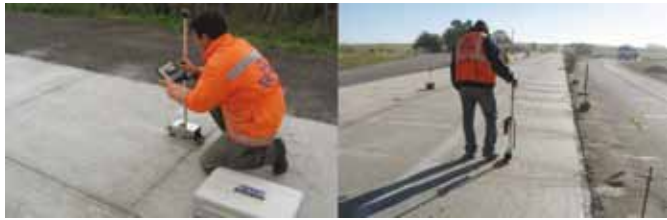
Fig. 14. Registro de la regularidad superficial mediante el uso de un perfilómetro pivotante.
