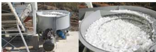
Fig. 6. Dosificador automático de las macro fibras, instalado en la planta de hormigón.
