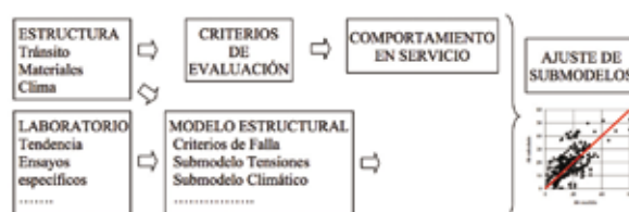
Figura 11. Esquema del proceso de ajuste de criterios/modelos
