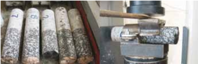
Fig. 13. Ensayo de adherencia por resistencia al corte en la zona de la interfaz HRF-asfalto.
