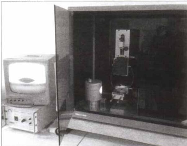
Foto 1. Goniómetro para la determinación de ángulos de contacto
