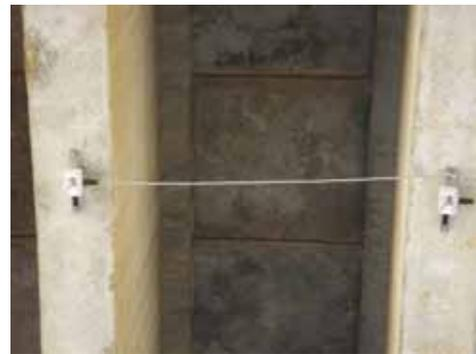
Foto 6. Vista de detalle de instrumentación de cada sensor en las vigas en puente instrumentado
