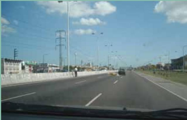
La fotografía muestra una sección de la Nueva Ruta 3 (Av. Brig. J. M. de Rosas), a la altura de Gonzalez Catán. A pesar de la amplia zona de camino con colectoras a ambos lados, no se ha previsto un boulevard central ni resguardo para peatones. Se ha preferido una configuración netamente vial con divisor "new jersey" privilegiando al automóvil y a la velocidad.
