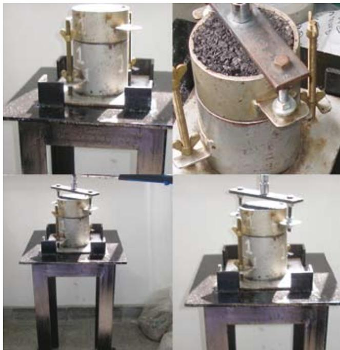
Las fotos, muestran el aspecto final de la mezcla en el sobremolde, como se monta el dispositivo de ensayo, la ubicación del molde en el soporte para el ensayo y la colocación final del Torquímetro.
