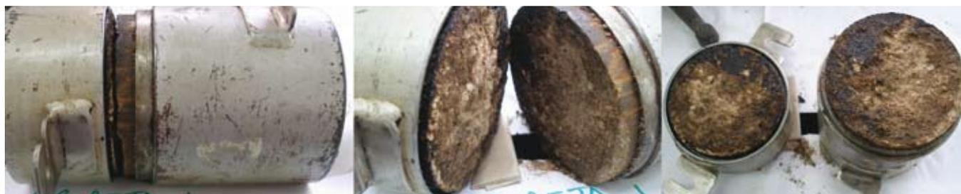
En los ensayos realizados a esta base, se trabajó con una Densidad Inicial del 100 %, la superficie fue dejada orear durante 18 horas período en el cual la humedad en la misma disminuyó alrededor de un 20 %.
