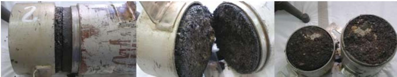
Al igual que en el caso anterior en los ensayos realizados a esta base, se trabajo con una Densidad Inicial del 100 %, la superficie fue dejada orear durante 18 horas período en el cual la humedad en la misma disminuyo alrededor de un 20 %.
