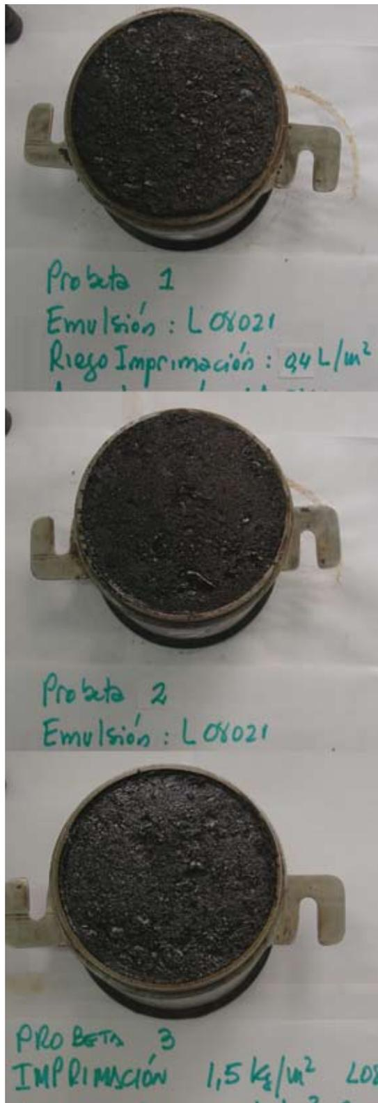
La mezcla asfáltica usada, corresponde a una mezcla del Tipo Densa, el moldeo de la misma dentro del sobre molde se lo hizo en dos capas de 25 golpes cada una y a la temperatura especificada por el ensayo Marshall, para posteriormente colocar el dispositivo y proceder al ensayo. Fotos 7, 8, 9 y 10.
