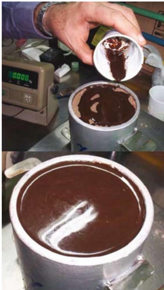
Estando el Riego de Imprimitación correctamente absorbido por la base Fotos 4 y 5, se coloca la Emulsión correspondiente al Riego de Liga, esta será de distintos tipos a los efectos de evaluar su eficiencia o aporte final. Foto 6.
