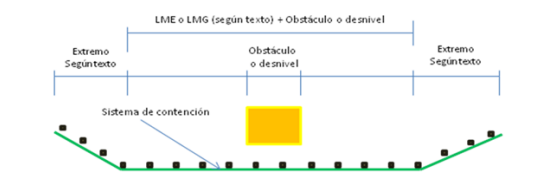
Figura 7. Longitud y ubicación de los sistemas de contención lateral en caminos de dos carriles indivisos.
