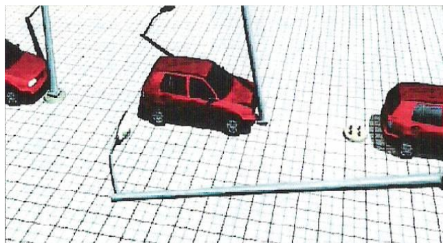
Postes frangibles con incorporación de fusibles en el basamento
