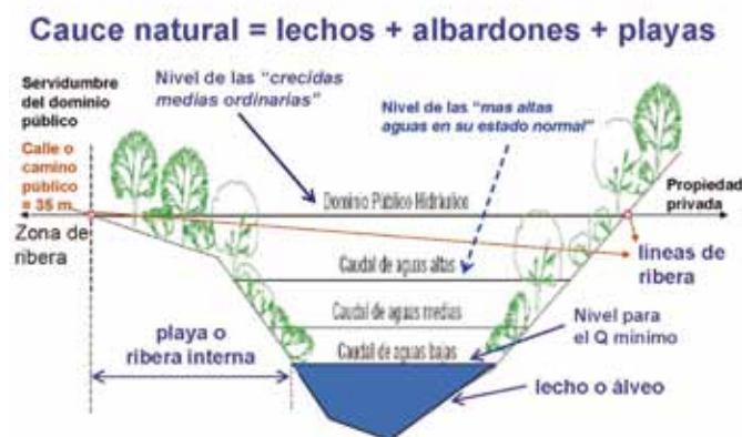
Figura 1.- Esquema sobre el cauce natural y las riberas.
