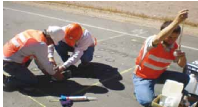
Figura 3 – Medición de residuo salino en estudios realizados por personal del 4º Distrito Mendoza de la DNV
