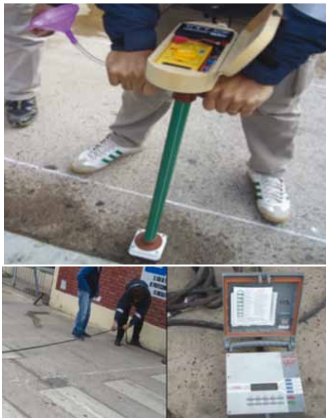
Fig. 6 – Colocación de medidores de tránsito en el sitio del experimento
