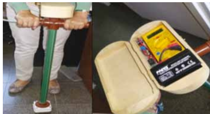
Figura 4 – Aparato desarrollado en la investigación en curso para medir residuo salino
