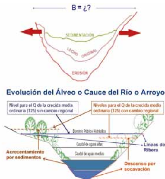
Figura 8.- Previsible evolución de los tramos fluviales y las líneas de ribera por efecto de causas naturales o inducidas.
