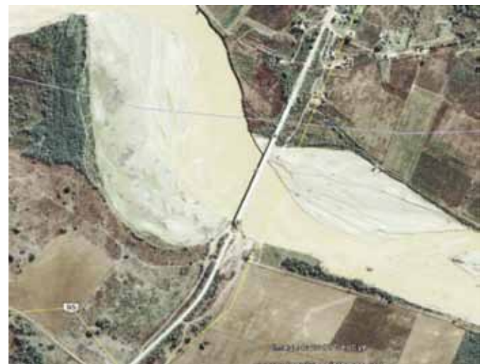
Imagen satelital en la que se observa cómo el meandro se recuesta sobre la margen derecha. Imagen del año 2004
