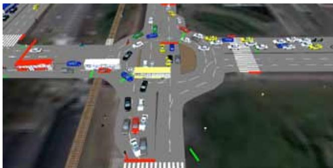
Figura 14: Imagen de la simulación de la rotonda partida
