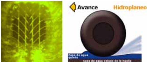
Figura 02. Escape del agua de la zona de impronta y condición de hidroplaneo
