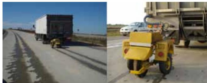
Figura 13. Medición de coeficiente de fricción con equipo Mumeter
