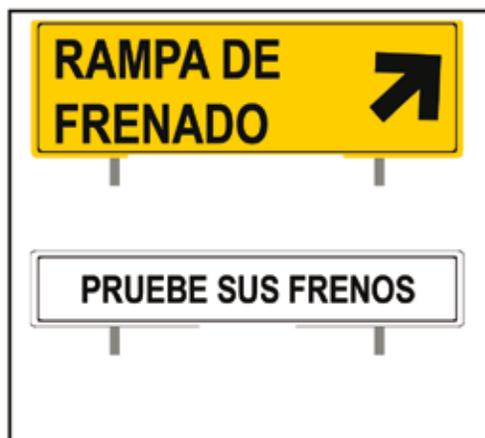
Figura 6– Señalización vertical de una rampa de escape. Adaptado: Norma Oficial Mexicana (2009).
