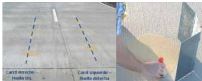
Figura 14. Medición de la profundidad media de textura por el método del círculo de arena
