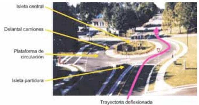
Figura 4: Elementos de una rotonda moderna
