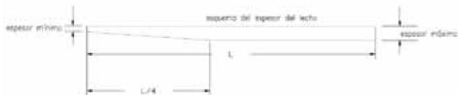
Figura 2 - Esquema del espesor del lecho de frenado. Corte.
