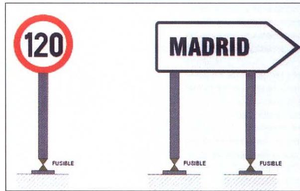
Figura 15. Fusibles estructurales en señales y carteles laterales.
