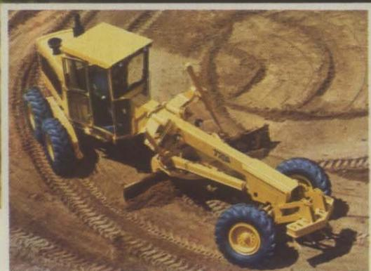
La articulación del bastidor permite mantener el tándem trasero sobre piso firme y ayuda a reducir el radio de giro.
