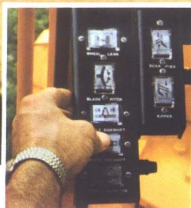
En la Motoniveladora 772A, los botones de comando controlan la inclinación de las ruedas delanteras, el ángulo de la hoja, el desplazamiento lateral del círculo, el desplazamiento lateral de la hoja, la rotación del círculo, el escarificador y el desgarrador.
