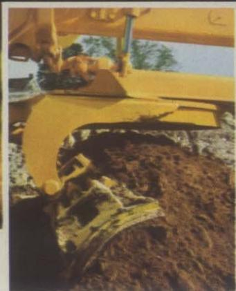
Los 54° de inclinación total de la hoja facilitan la acción de vuelco y desplazamiento de cualquier material.
