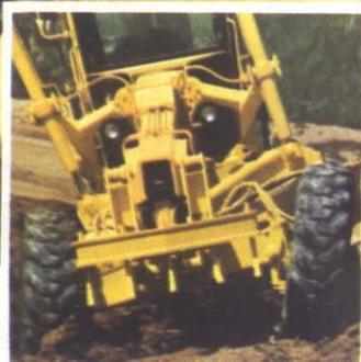
Las ruedas delanteras de la Motoniveladora John Deere pueden inclinarse 20° en ambas direcciones para controlar el tiro lateral y reducir el radio de giro.
